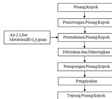
Gambar 1 : Diagram Alir Pembuatan Tepung Pisang Kepok Merah
